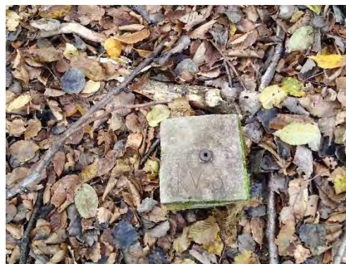
Obr. 29: Pozorovací meračský bod KV-8.
