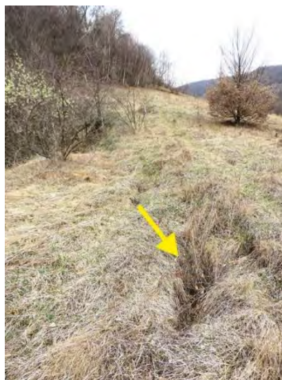
Obr. 42: Aktívne osypy na závale Z10. Obr. 43: Trhlina 1 pri závale Z1.
